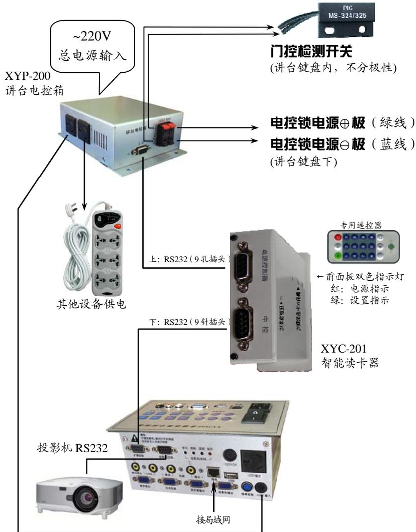
注意：本讲台采用全钢结构，为了使用安全，请务必将讲台进行可靠接地处理，强烈建议安装漏电保护器。
