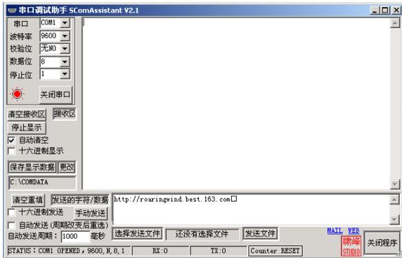
先选择 COM □，再选择写码时一样的波特率和校验位，将【十六进制显示】选项选择上，这时按一下面板控制键就可在编辑窗口中显示是否收到正确的控制代码。如果收到的代码和写入的代码一样，那么写码过程就成功的完成了。如果接收到的代码与写入的不一致，请重新进行写码操作（需将调试软件关闭后再写码）。
