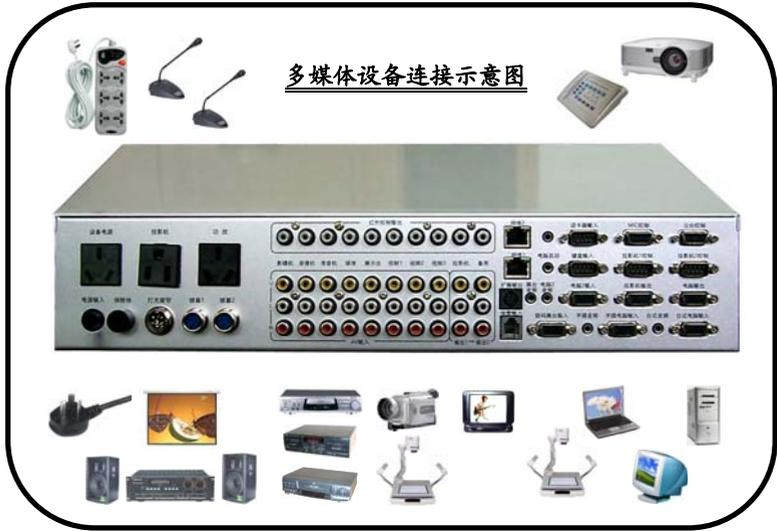
用户按以上连接图将设备一一对应连接，红外发射头贴在相应设备的红外接收窗处，投影机电源一定要插在中控的投影机专用电源插座。
